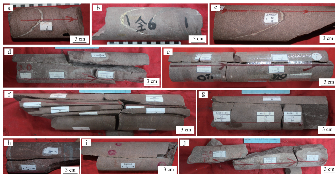
图3 库车坳陷克深8气藏巴什基奇克组岩心构造裂缝
